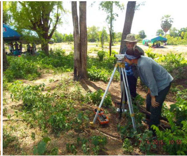
การใช้เครื่องสำรวจหยั่งลึกด้วยสัญญาณเรดาร์ตรวจสอบในหลุมขุดค้น (ซ้าย) การใช้กล้องระดับในการทำผังบริเวณ (ขวา)
