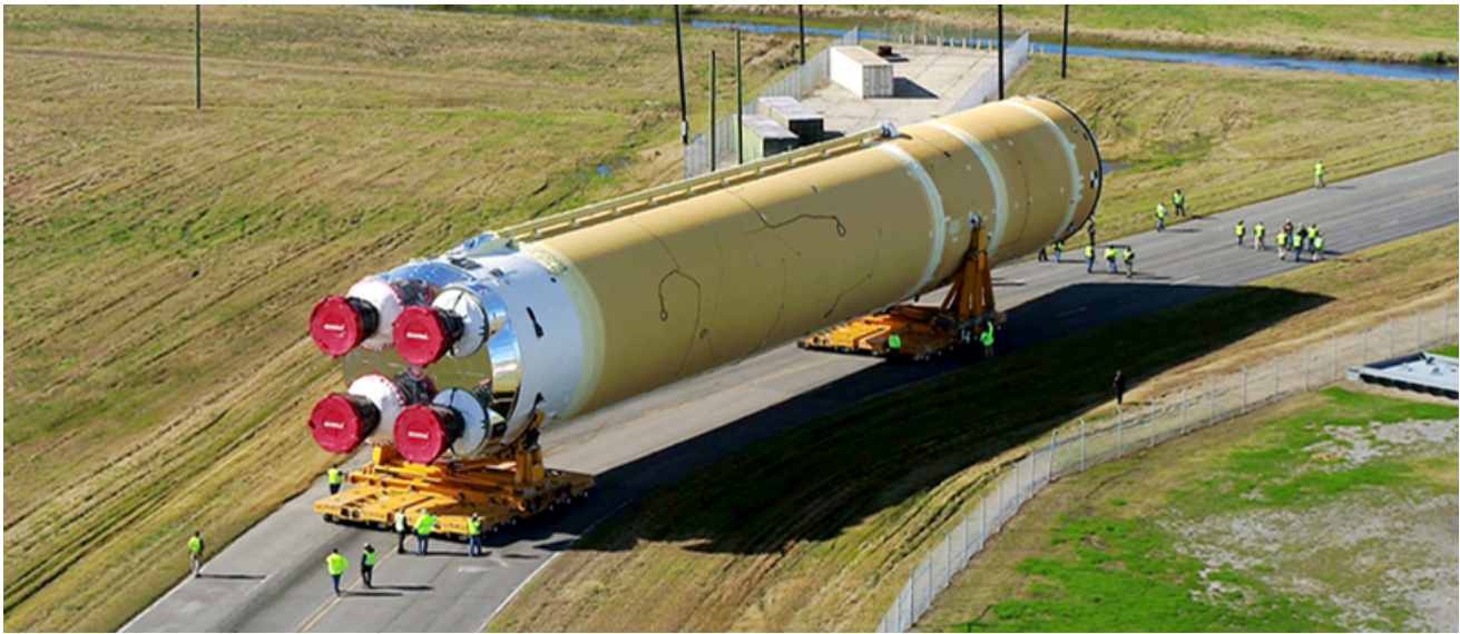
ชั้นแกนกลางของจรวด (core stage) และเครื่องยนต์ RS-25 จำนวนสี่เครื่องยนต์ที่ติดตั้งกับชั้นแกนกลางของจรวด (ที่มา: https://www.nasa.gov/directorates/esdmd/space-launch-system-ftdku/ )
